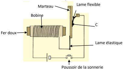
Ci-dessus le schéma d'une sonnerie électrique. Décrire ce qui se passe quand on appuie sur le poussoir de la sonnerie. Qu'est ce qui fait vibrer la lame ?
