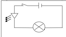
Le circuit comprend une pile, un interrupteur, une lampe et une DEL. On ferme l'interrupteur la lampe s'allume, la DEL aussi s'allume.
