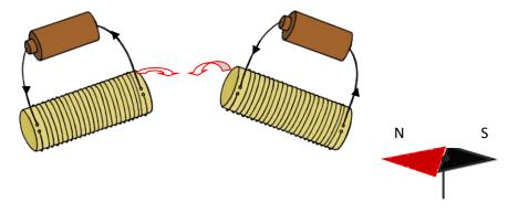
Après on inverse le sens du courant dans l'une des bobines les deux bobines se repoussent.
