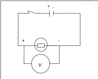
Réalise un circuit simple comprenant une pile « 4,5V », un interrupteur et une lampe « 3,8V » reliés par des fils électriques.
