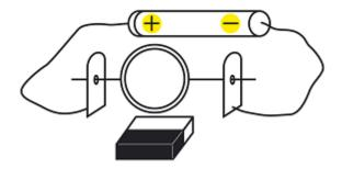
On relie les fils d'une petite bobine aux bornes d'une pile. On approche un aimant de la bobine. La bobine se met à tourner.
