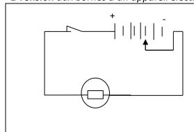
a) - Tu disposes d'un circuit simple comprenant une lampe neuve portant l'indication technique «3,8V », un interrupteur et un boîtier contenant 4 piles « 1,5V » neuves associées en série (voir schéma cicontre). On peut déplacer la borne négative de l'association de piles. On ferme l'interrupteur et tu observes la brillance de la lampe quand le nombre de piles utilisées est 1, 2, 3, 4.
