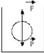
Si  $P < F$  alors le corps immergé monte en surface, le volume  $V$  d'eau diminue, l'intensité du poids devient alors égale à celle de la poussée, on dit que le corps flotte.
